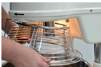
3 Protection amovible et rotative avec visière adaptable
